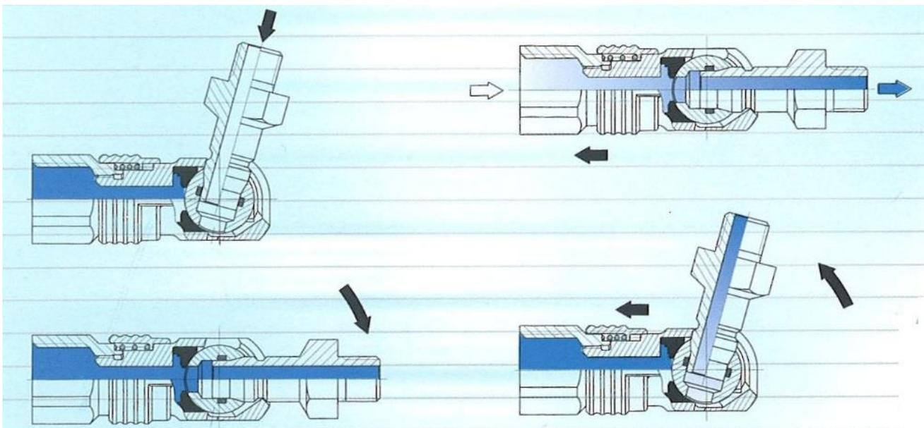
Voller Durchgang ohne Umlenkung der Strömung
